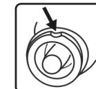
2. Há uma marca no batoque que indica saída de ar. Para facilitar a formação das gotas, posicione-a para cima.
